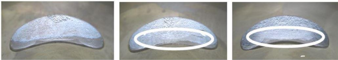
11.9.6) 배기포트 내측의 둘레부분은 주조 후 버(Burr)를 제거하기 위해 위 사진과 같이 CNC 가공 및 수동 연삭 등의 흔적이 남아있을 수 있다.
